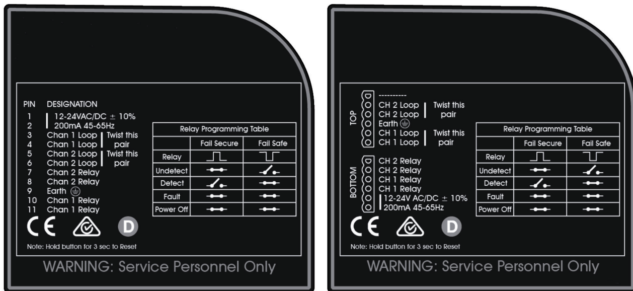
Bild 8. Beispiel eines LC20-2-Typenschildes. Die Stromversorgungsanforderungen und Polverbindungen sind an der Geräteseite deutlich angegeben. Die 11-polige Konfiguration wird links gezeigt, und die DIN-Schienenversion rechts.
